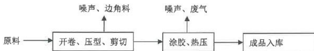
图2-2 彩钢复合板生产工艺流程及排污节点
