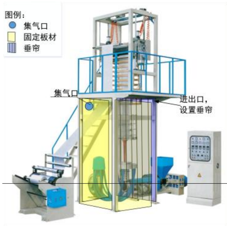
图 4-1 吹膜机废气收集示意图
